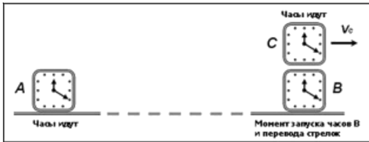
Рис.62 Синхронизация с помощью равномерного переноса часов. Процедура синхронизации разнесённых в пространстве часов сводится к запуску часов A и передаче их показаний часам B посредством часов C методом равномерного их переноса.
