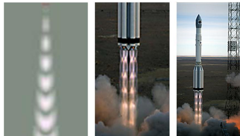
Рис.20а Распределение волновой энергии от множества источников (модель слева), находящихся в сверхзвуковом режиме движения ( 12\text{Mach} ). Похожий процесс имеет место и в сверхзвуковых реактивных струях.
