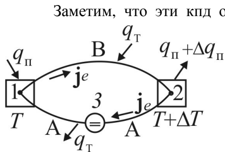
Рис.3. Схема термоэлектрического преобразователя энергии
