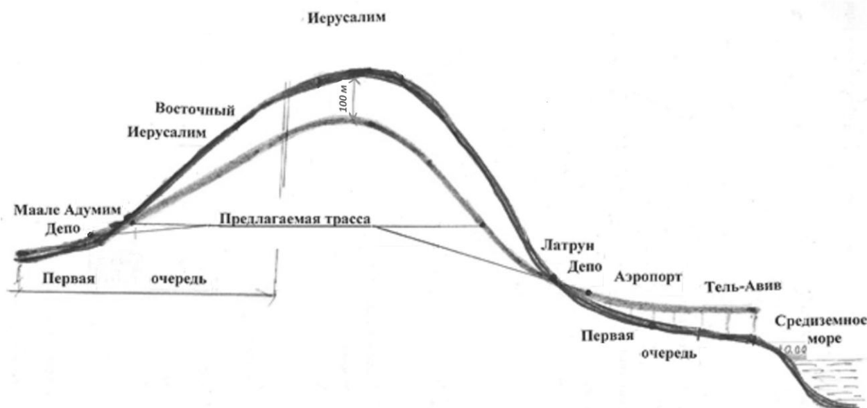
Рис. 3. Разрез и принципиальная схема линии метро
